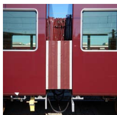
連結面間転落防止装置 (阪急電鉄)
