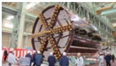
トンネルを掘削するシールドマシン
