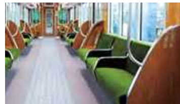
大型袖仕切り・縦手すり
