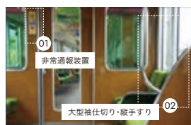
非常通報装置・大型袖仕切り・縦手すり(阪急電鉄)
