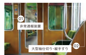
非常通報装置・大型袖仕切り・縦手すり(阪急電鉄)
