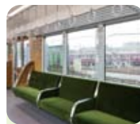
UVカット複層ガラスの側窓
