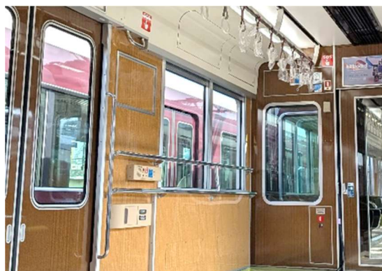
改良工事後の車いすスペース
