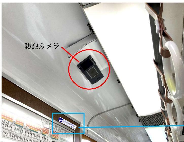
防犯カメラの設置イメージ (乗降ドアの上部)
