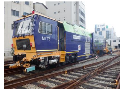
大型保線用機械「マルチプルタイタンパー」
