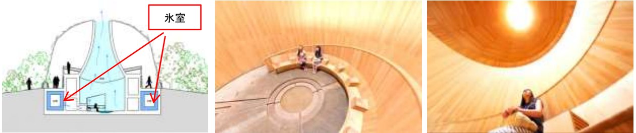
六甲山に吹く風を「氷室」に取り込む 「風室」のヒジ置き部分から冷風が吹く 天井部分の穴から空気が排出される
