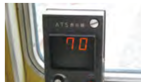
③ 運転台ATS表示器
