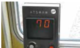
③ 運転台ATS表示器
