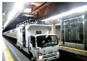
架線検測車による摩耗測定
